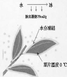
圖一 噴霧灑水法乃利用水分結冰時放出79 cal/g的潛熱，提供葉片吸收，以達到保溫防凍霜效果。本圖修改自 http://www.ochakaido.com/juku2/kihon/img/k/3w007.gif 。
