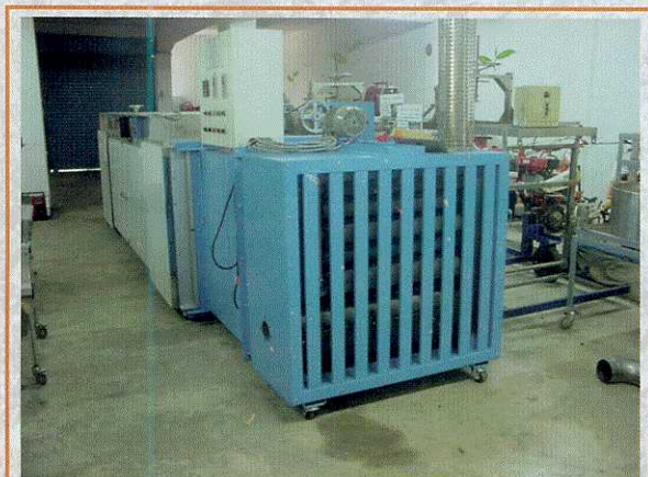
圖1 多層式茶菁萎凋機(三層式可作為熱風萎凋兼乾燥用)
