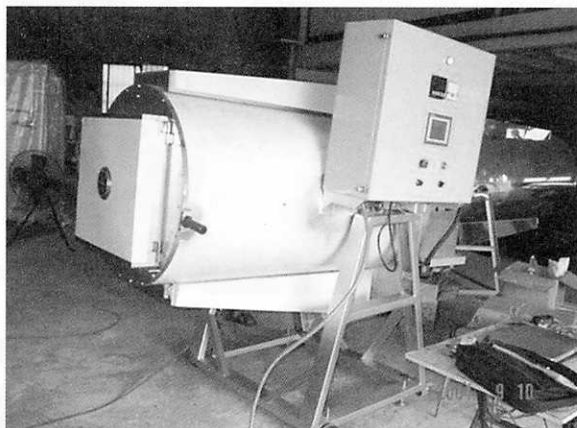
圖 2. 滾筒式烘焙機外觀類似炒菁機，其控制部安裝於側邊支架上
