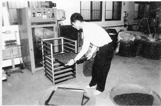
圖 1. 傳統電熱烘焙箱置入茶葉作業情形
