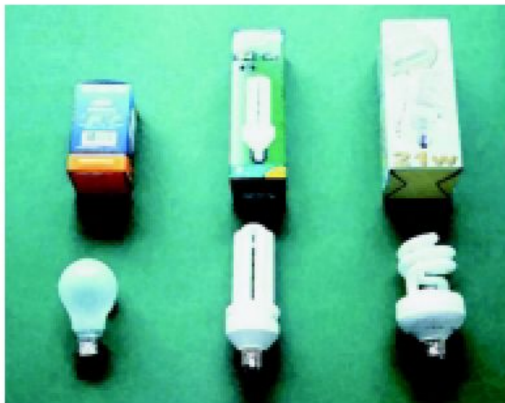
三種參試燈泡。自左而右分別為100W鎢絲燈泡及20W, 21W省電燈泡
