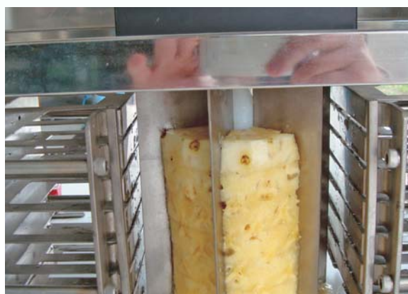
圖5. 切片機構作動情形
