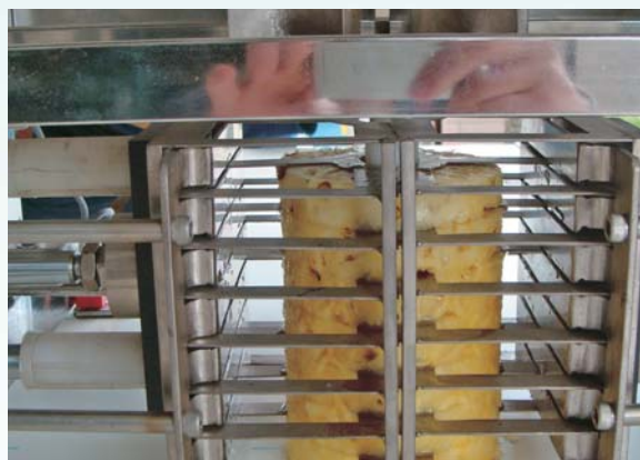
圖6. 切塊機構作動情形
