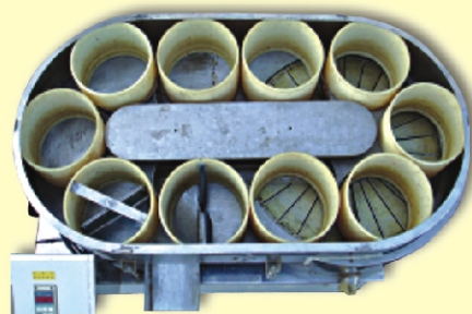
圖2. 儲料桶及削刀盤總成
