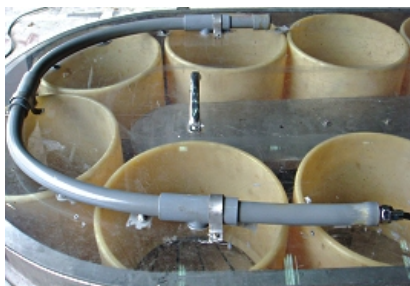
圖5. 削皮過程之沖洗裝置
