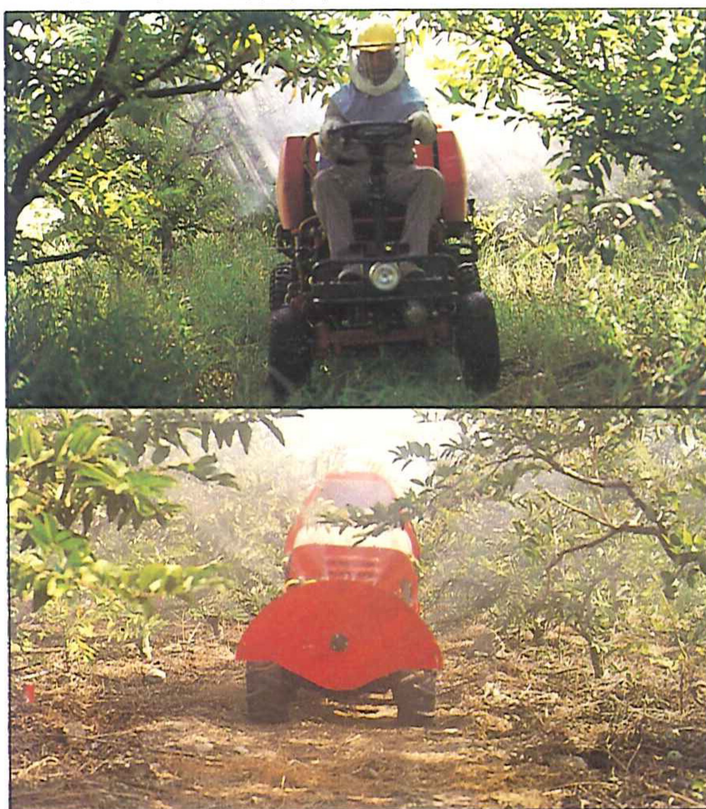
護蓋式鼓風噴霧車撒佈霧粒微粒化之情形
