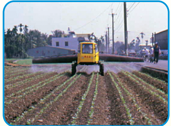
圖2.採用氣輔桿式噴藥車進行病蟲害防治
