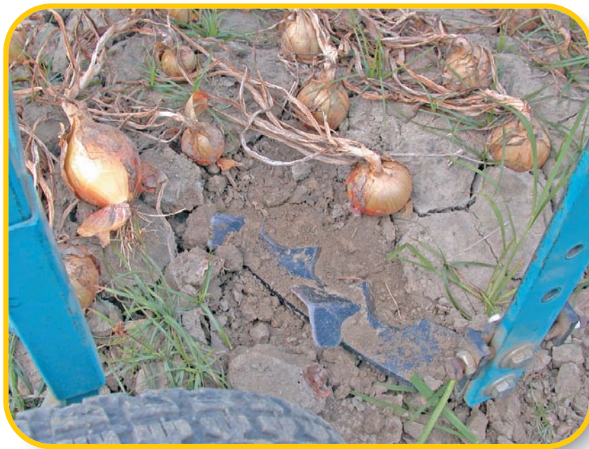
▲ 圖 11. 挖掘刀深入葱球根部下破裂土壤
