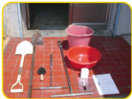
◀圖8. 蓮霧園土壤採樣工具(左至右，圖鏟、鋤頭、移植鏟、土管、土鑽；右上至下，水桶、水盆、採樣盒、紙袋、油性筆、筆、記錄紙)。
