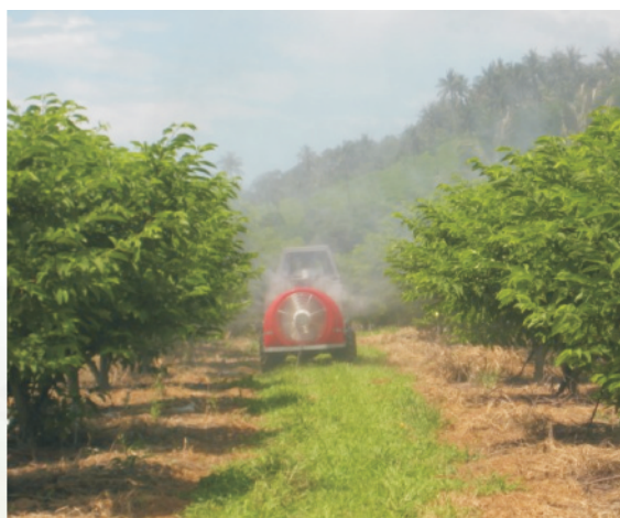
圖9.鼓風式靜電噴霧車撒布霧粒細化
