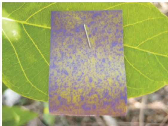
圖7.鼓風式靜電噴霧車撒布在番荔枝葉面附著情形
