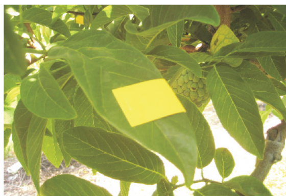
圖6.鼓風式靜電噴霧車進行撒布附著量試驗，試驗前在葉片兩面懸掛水試紙。
