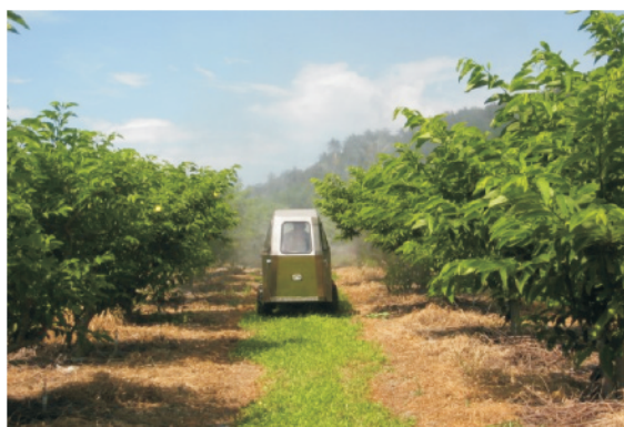
圖5.鼓風式靜電噴霧車在番荔枝果園進行撒布附著量試驗情形
