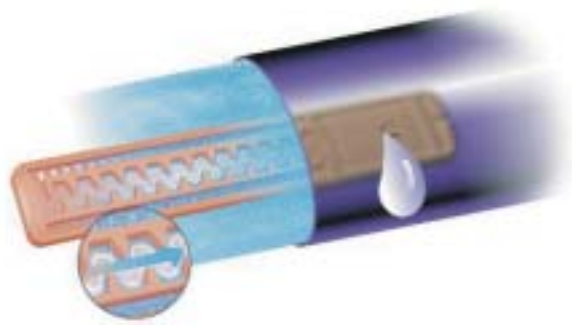
滴灌管的構造示意圖（取自Netafim網站）
