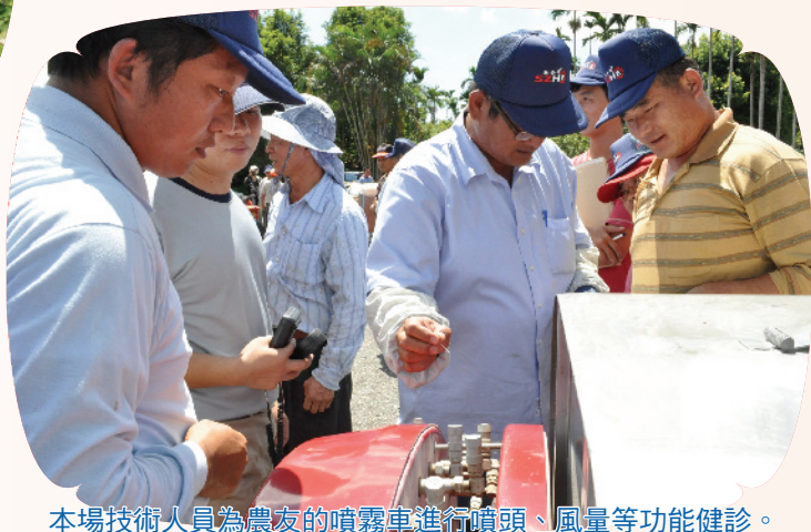
「果園鼓風式靜電噴霧車」每公頃作業時間比傳統人工施藥方式約快8倍，施藥量比傳統節省30%以上，是農友進行病蟲害防治作業時的好幫手，省時省錢、安全又環保。
