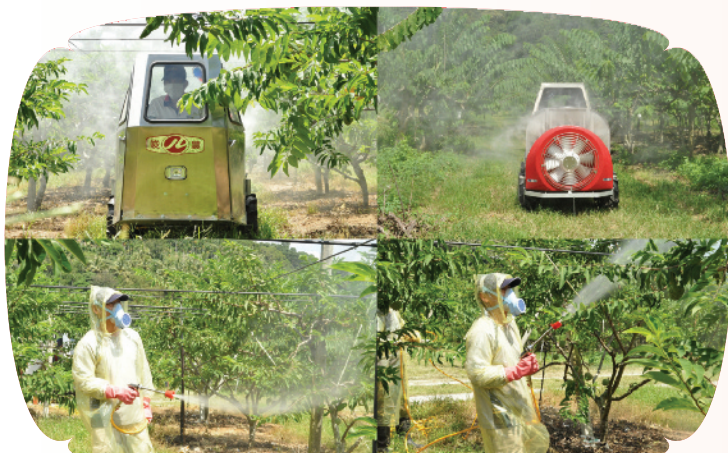
「果園鼓風式靜電噴霧車」每公頃作業時間比傳統人工施藥方式約快8倍，施藥量比傳統節省30%以上，是農友進行病蟲害防治作業時的好幫手，省時省錢、安全又環保。
