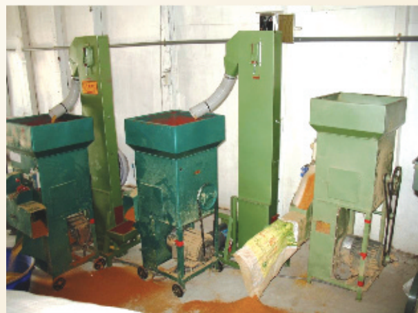
三台脫殼機及二台輸送機串聯成連續式脫殼一貫化作業機
