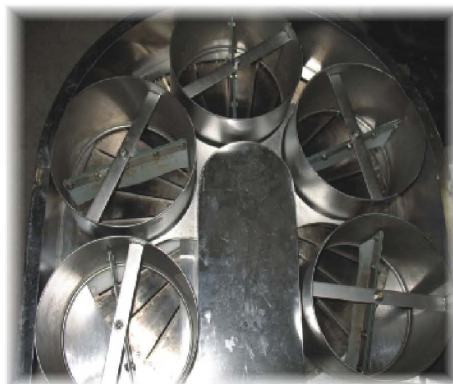
削皮機之進料圓桶及削皮刀盤的構造
