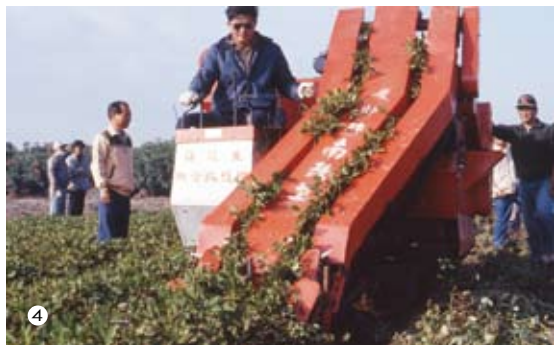
③ 履帶型掘取投入脫莢式落花生聯合收穫機 ④ 南改型履帶式落花生聯合收穫機
