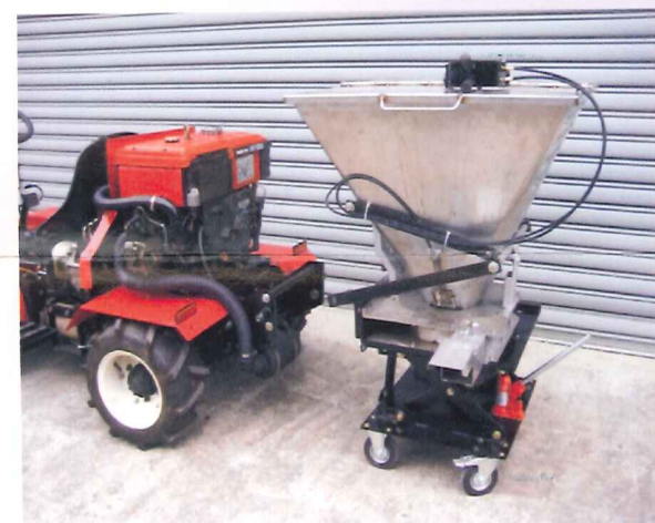
本機與施肥機總成拆卸分離
