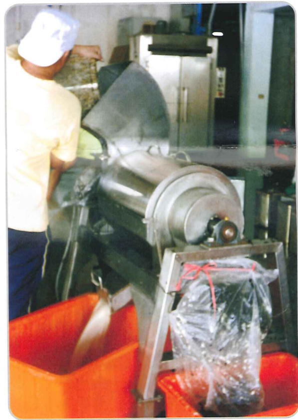
將軟熟削皮後之鳳梨釋迦果肉整顆投入鳳梨釋迦果肉分離機進行操作情形
