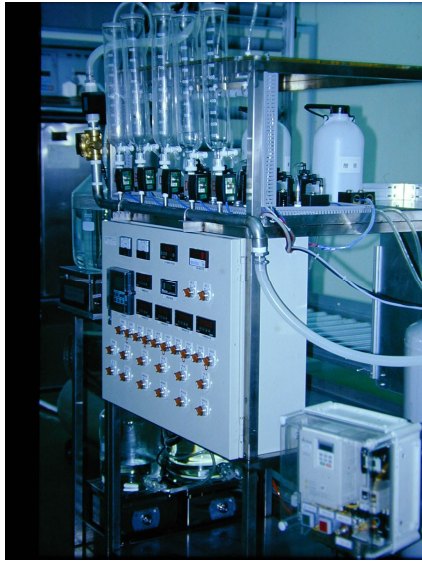
圖一、培養基自動配藥系統
