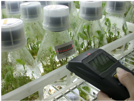
圖五、組織培養條碼管理系統
