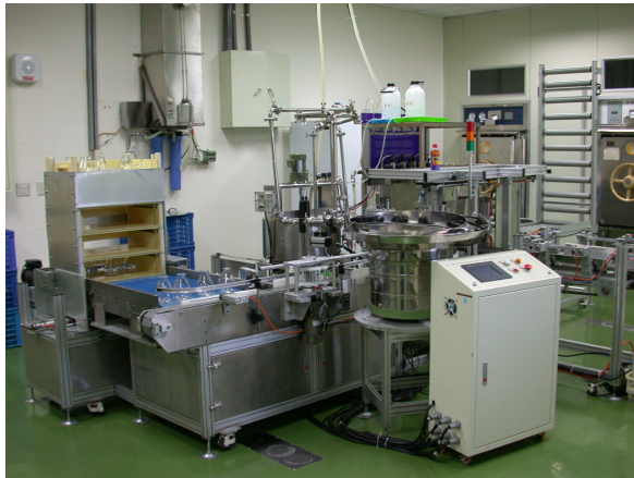
圖二、培養基自動充填系統
