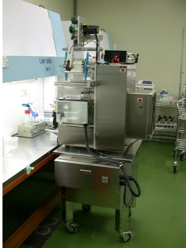
圖四、塑膠培養瓶自動封膜系統
