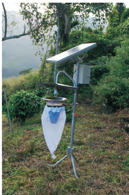
圖9. 吸入式太陽能捕蟲器
