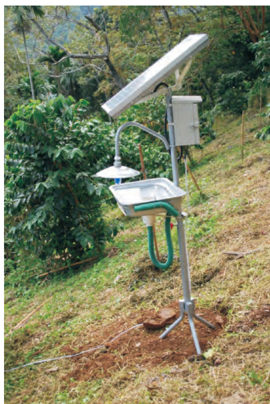
圖8. 溺水式太陽能捕蟲器
