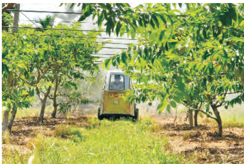
圖14. 果園鼓風式靜電噴霧車田間施藥情形
