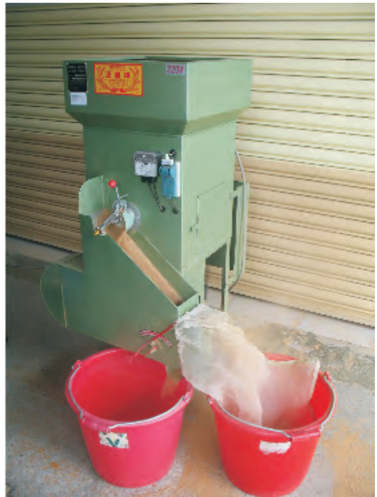
圖4. 臺灣藜以市售小型碾米機進行脫殼作業情形
