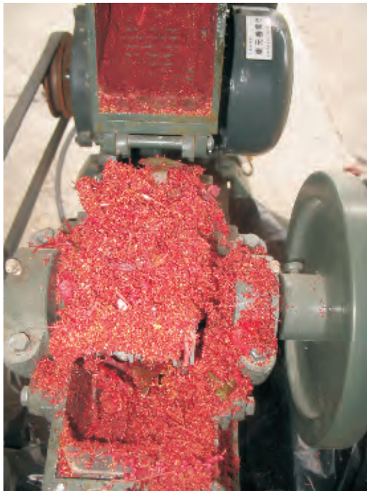
圖3. 未曬乾的臺灣藜以錘刀式粉碎機粉碎脫粒過程中，物料會黏著於機體內壁及阻塞過濾篩網孔的情形。
