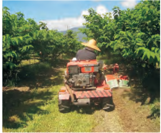
圖7. 果園側移式中耕除草機果樹冠下中耕作業情形
