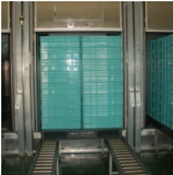
▲左邊外銷蒸熱場的蒸熱設備，淺綠色塑膠籃內裝木瓜，由堆高機推入蒸熱車中。
