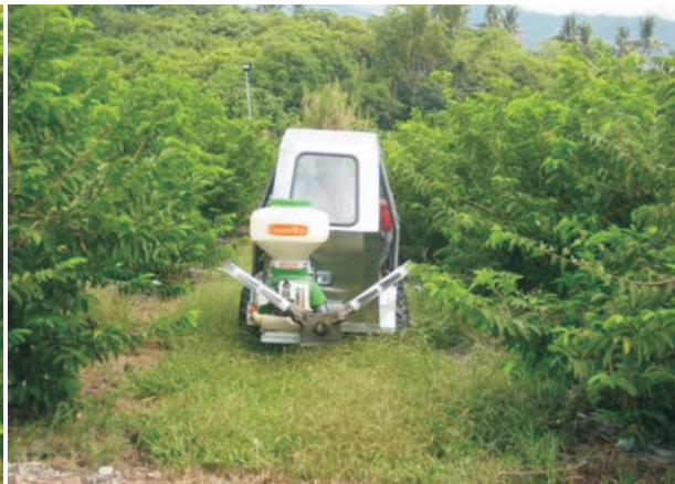
圖 21. 背負式微粒撒布機安裝在自走式噴霧車上，進行螞蟻餌劑撒布作業
