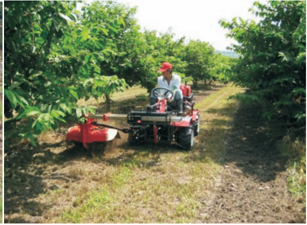
圖 3. 果園側移中耕除草機果樹冠下中耕作業
