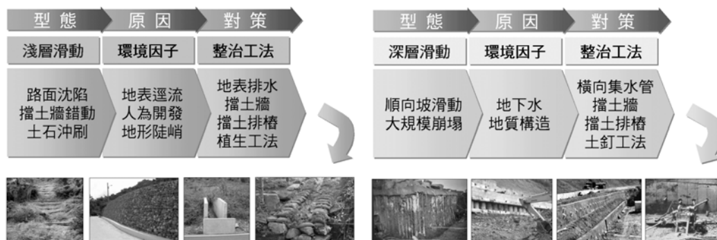
圖 4-3-2 崩塌地治理工法選擇示意圖
