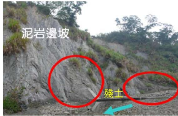
地母橋下游轉彎處，有一處長度約 150m 之近岸崩塌。
