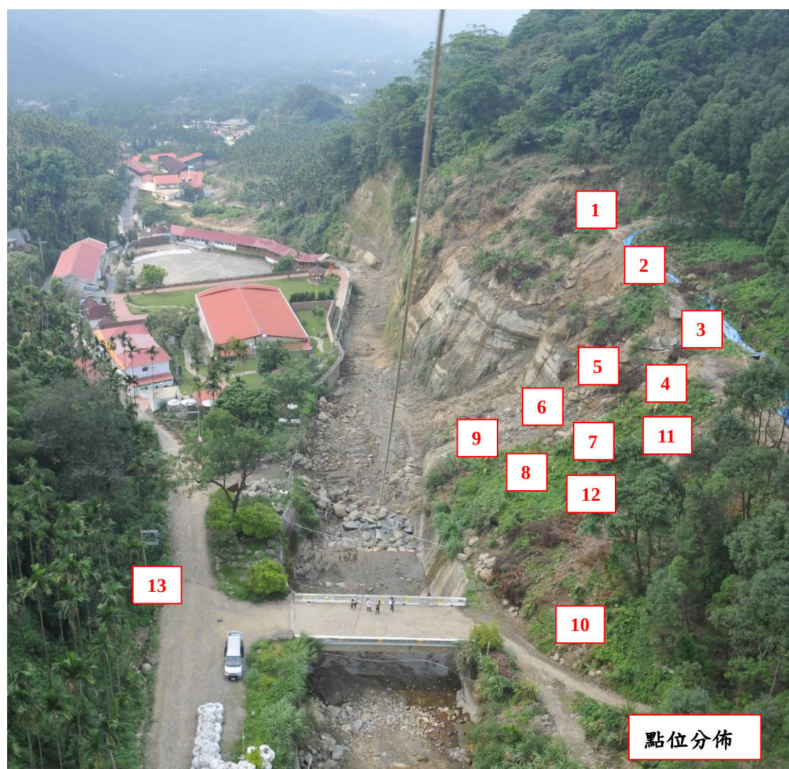
圖 5-1 地表變位量測點佈置圖
