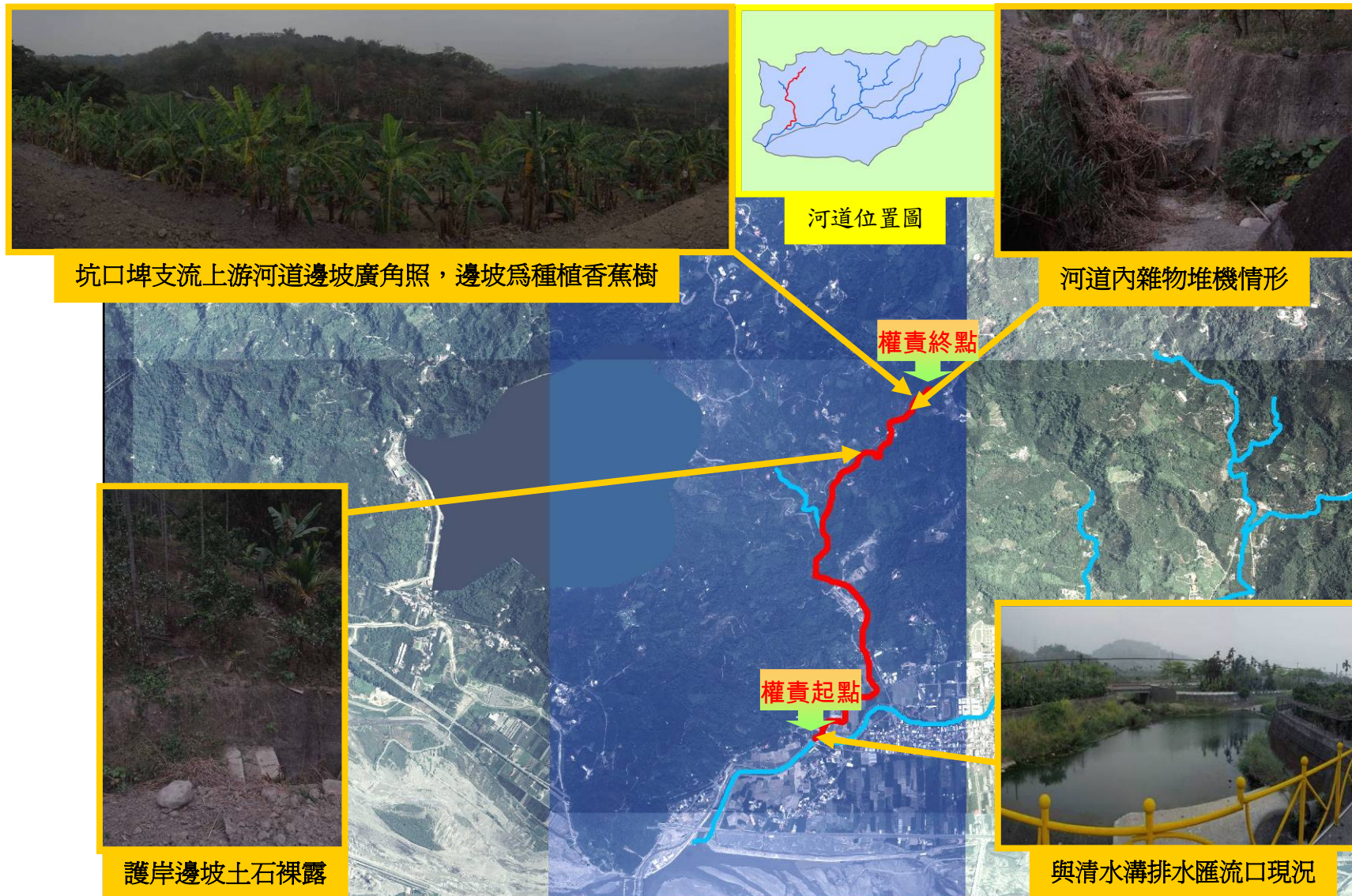
圖3-5-13 坑口埤排水現況說明及現勘照片
