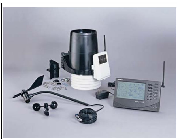
圖3-3-1 Wireless Vantage Pro 記錄器
