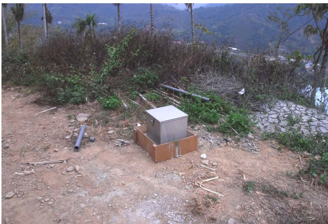
圖3-3-24 TDR保護箱完成照片
