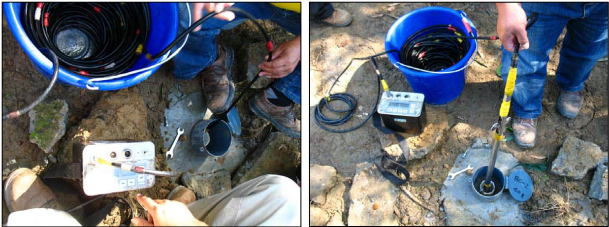
圖 4-5-10 傾度管現場量測及儀器照片
