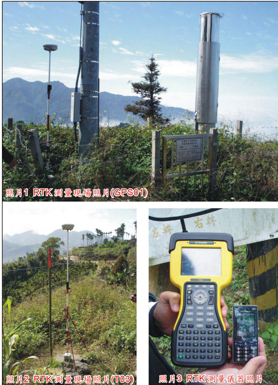
圖 4-4-5 坡面監測樁 VBS-RTK 定位測量現場作業照片
