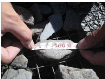
照片 7 量測各樣孔最大粒徑(1/2 吋)
