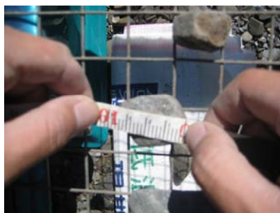
照片 8 量測各樣孔最大粒徑(3/8 吋)
