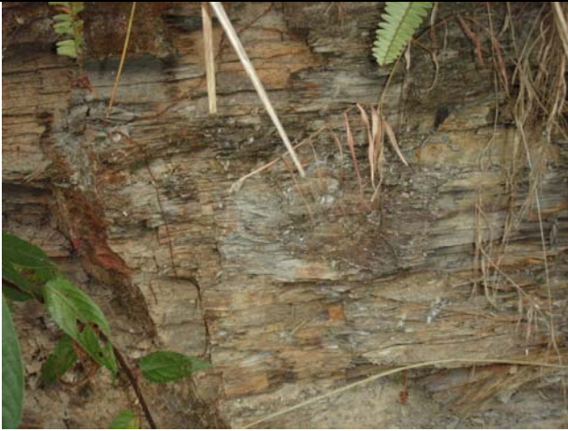
照片一 崩塌裸露岩性主要為棕灰色板岩，劈理相當發達，劈理位態呈 N15^{\circ}\sim25^{\circ}E/20^{\circ}\sim30^{\circ}E ，節理有兩組， J1=N40^{\circ}\sim45^{\circ}E/60^{\circ}\sim70^{\circ}NW ， J2=N45^{\circ}\sim55^{\circ}W/75^{\circ}\sim85^{\circ}NE 。
