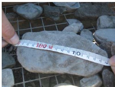
照片 6 量測各樣孔最大粒徑(1 吋)
