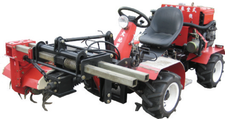
果園側移中耕除草機中耕構造
