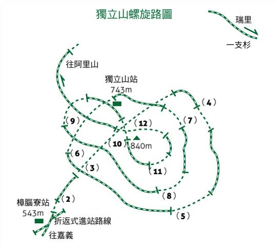
圖1 阿里山鐵路的螺旋形路線 (n)隧道號碼
