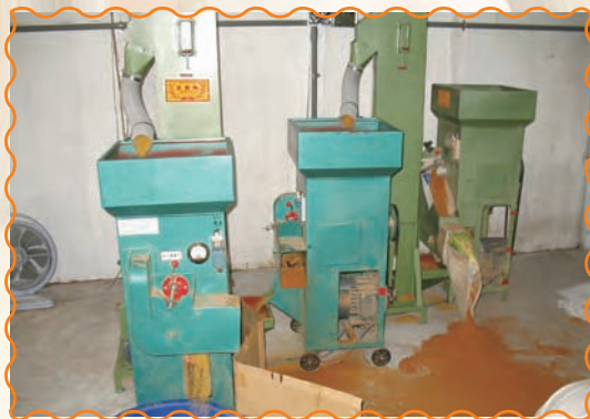
三台脫殼機及二台輸送機串聯成連續式 脫殼一貫化作業機
