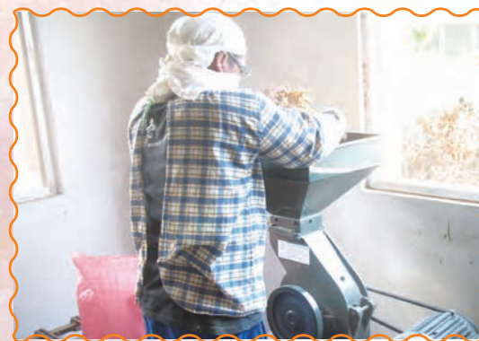
錘刀式粉碎機進行小米脫粒作業
