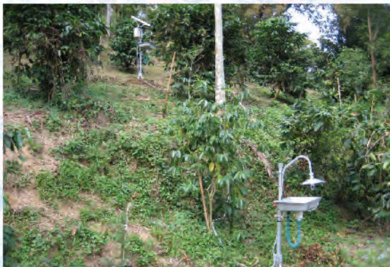
圖2. 溺水式太陽能捕蟲器一對二方式安裝
