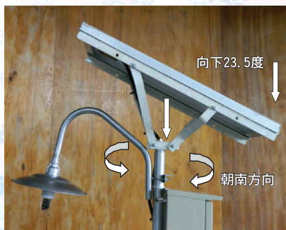
圖4. 太陽能板可調整角度及方向
