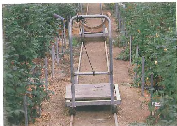
圖15. 設施內設置軌道方便運輸，既省工又經濟。
