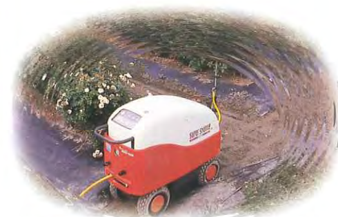
圖20. 自走式噴藥機可自行噴藥但購買價格較高，且要配合適當的畦寬，以大面積（約5公頃）施用才划算。
