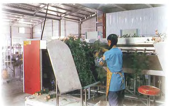
圖12. 利用花卉分級機可大量作業、迅速、確實。
