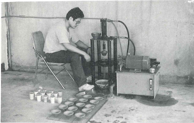
圖六 玉米穗軸成型機將穗軸漿料壓縮成形
