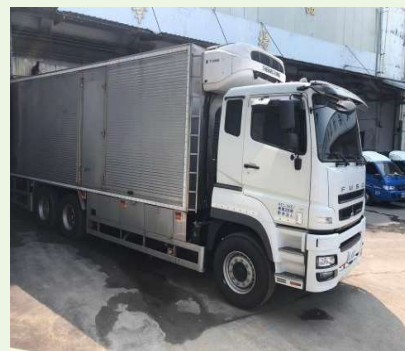
▲ 屠體運輸車輛溫控設備
