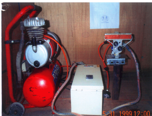
圖 4. 手持式芒果套袋機具外觀
