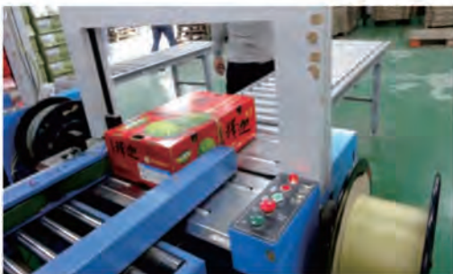
圖17. 果品自動打包作業
