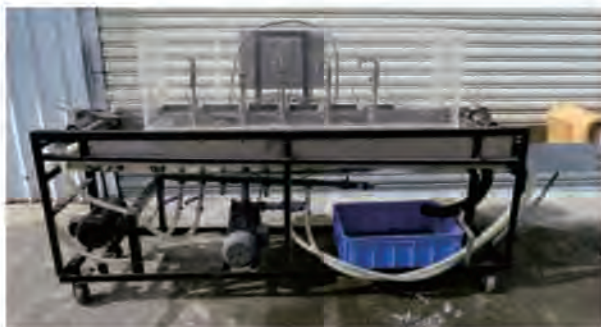
圖26. 水洗式之鳳梨釋迦粉介殼蟲清除機械
