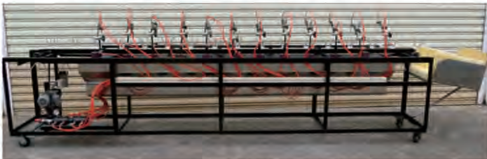
圖24. 研製完成之氣吹式鳳梨釋迦粉介殼蟲清除機械
