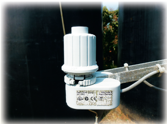
▲圖18. 自動灌溉控制器可搭配雨量計，於下雨期間停止灌溉。
