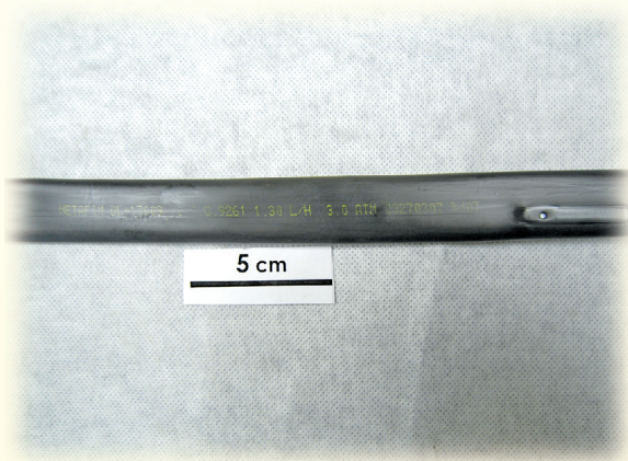
▲圖12.在滴灌管上通常標有規格與條件，圖片中滴灌管出水量為1.3公升/小時。
