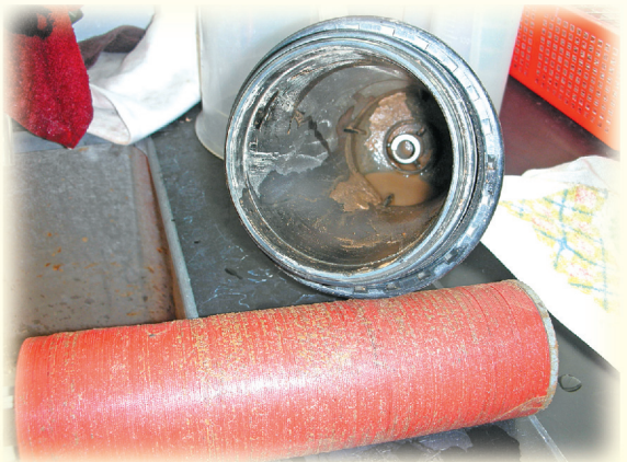
▲圖2. 可利用碟式過濾器判斷灌溉水是否可直接被利用，過濾器內部若容易阻塞則需進一步採用砂濾等過濾系統。
