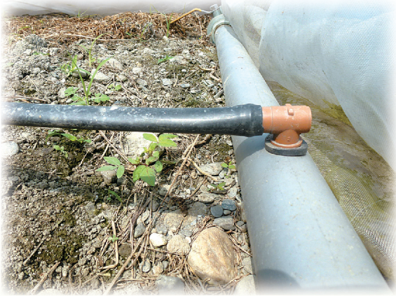
▲圖13.滴灌管與供水管利用管首接頭相接，十分便利。
