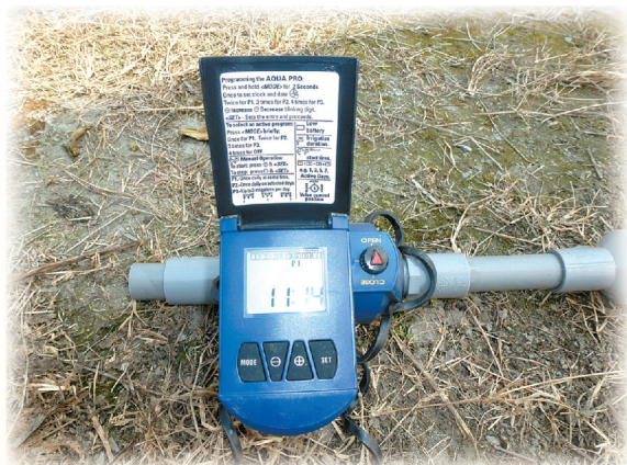
▲圖19. 直流電電磁閥配備單區控制器
