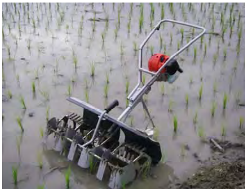
圖 1. 本場研成之三行式有機水稻田中耕除草機
