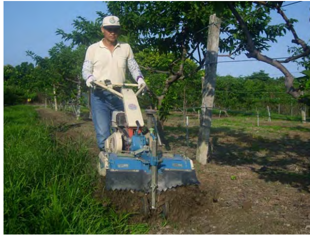
圖 2. 施在地面上之土壤改良資材，可利用中耕機與土壤充分混合以發揮最大功效。
