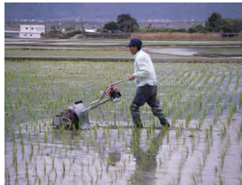
圖 2. 有機水稻田中耕除草機實地操作情形
