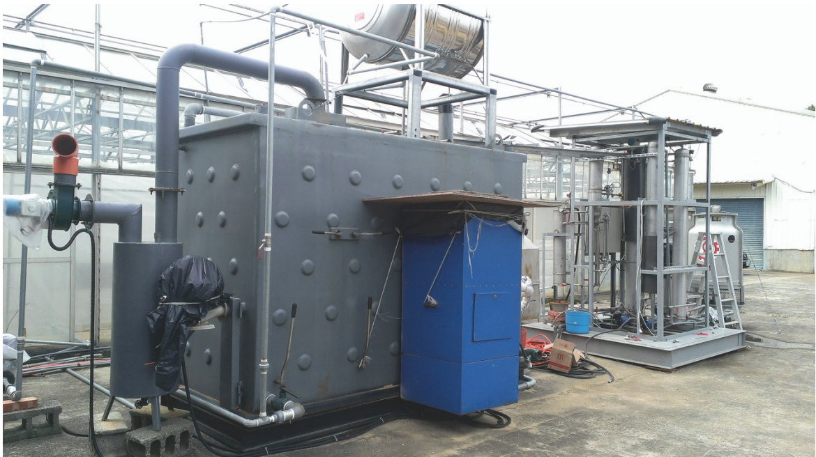
圖 4. 生物質鍋爐結合氨水吸收式製冷系統
