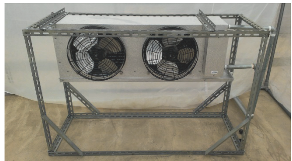
圖 6. 溫室內部之熱交換機組風扇
