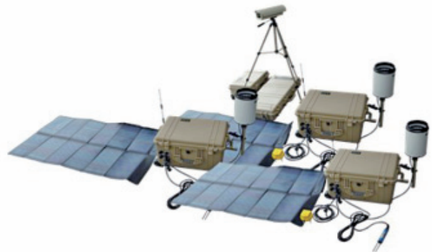
圖 3-3 簡易式土石流觀測站
