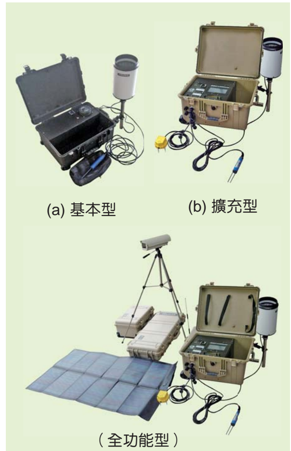
圖 3-3 簡易式土石流觀測站
