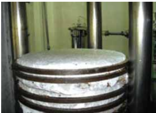
圖 9-3 壓榨茶籽的立式榨油機
