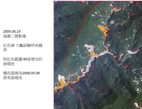
圖5 莫拉克風災扇平林道崩塌變動範圍
