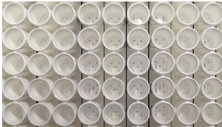
圖五、利用反轉錄聚合酶連鎖反應(reverse transcription-PCR, RT-PCR)結合晶片呈色, 進行茄科類病毒等病原檢定之晶片(測試中)。
