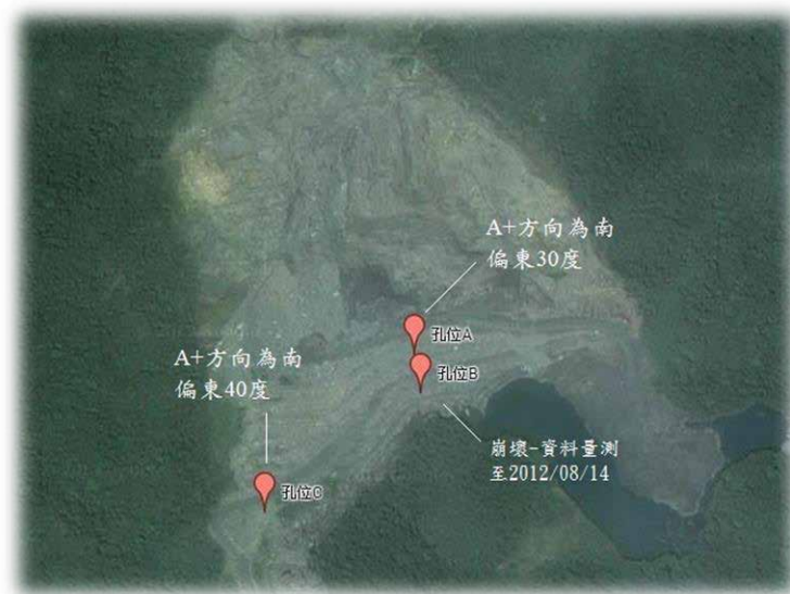
圖 7 龍泉溪傾斜管監測孔位分布位置
