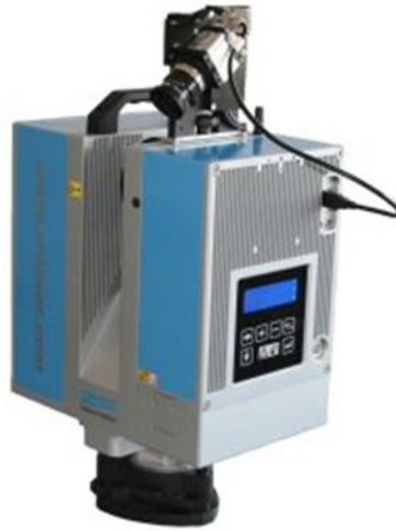
圖 4 三維雷射掃瞄儀 Z+F IMAGER® 5010
