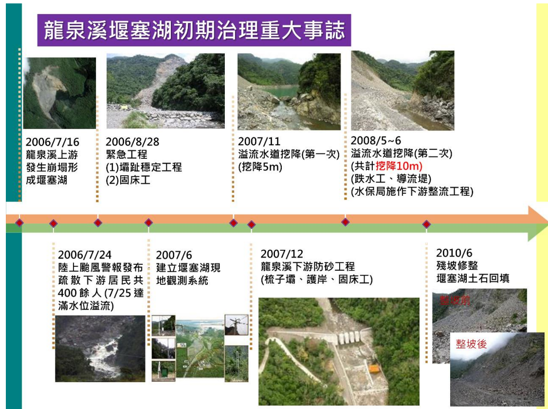
圖 3 龍泉溪堰塞湖初期治理重大事誌
