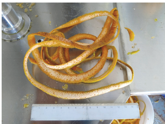
圖 3、使用本機削下的桶柑外果皮情形
