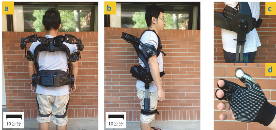
圖 2、本文所使用的外骨骼搬運服：(a)前視圖；(b)左視圖；(c)馬達裝置圖；(d)手指壓力感測器開關手套
