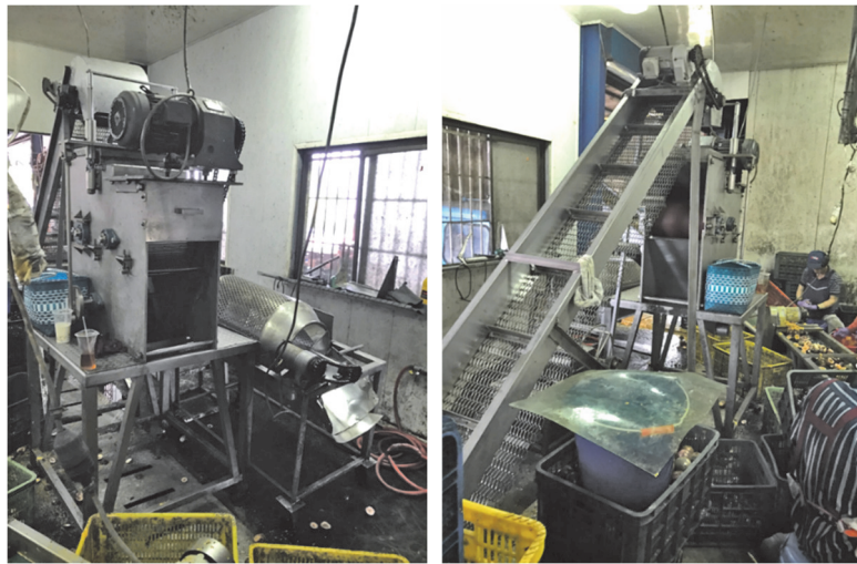
圖 1、傳統的壓榨式取漿機械，因會造成果皮藥劑污染果漿而多廢棄不用
