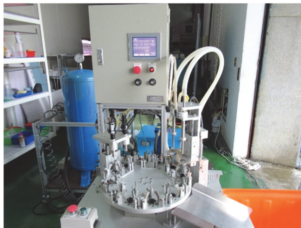
圖 3、百香果取漿機械主要各部結構與取漿作業程序所對應的機構位置
