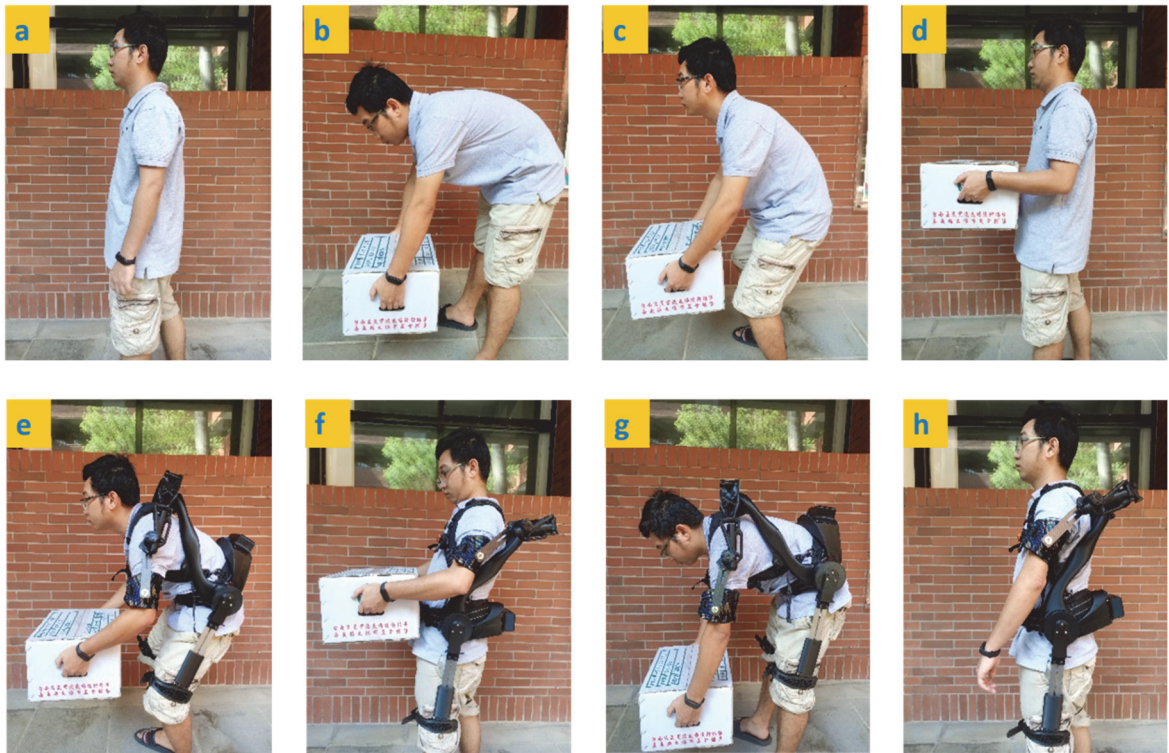
圖 1、搬運模擬作業圖。圖(a)至(d)步驟為未穿戴外骨骼省力服進行搬運作業，圖(a)為抬舉動作、圖(b)為負重步行、圖(c)則為放置中物、圖(d)為未負重步行；圖(e)至(h)步驟為穿戴外骨骼，分別測試抬舉、負重步行、放下、未負重步行進行搬運作業
