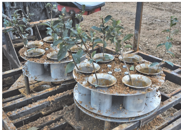
圖 4、待種植茶苗預先放置投苗機構情形
