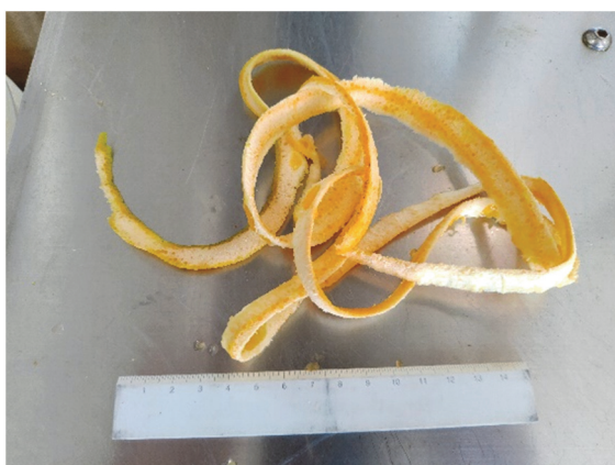
圖 4、使用本機削下的桶柑中果皮情形
