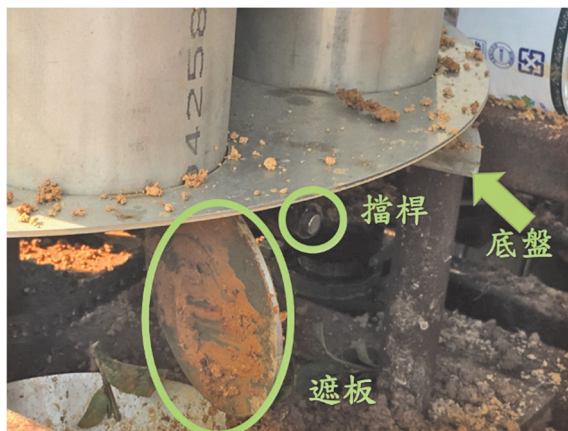
圖 5、遮板後方設計擋桿
