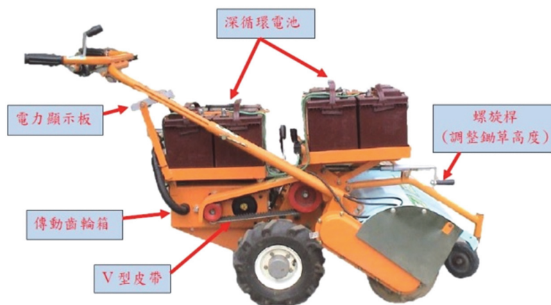
圖 1、嘉義大學 2011 年開發之電動中耕鋤草機
