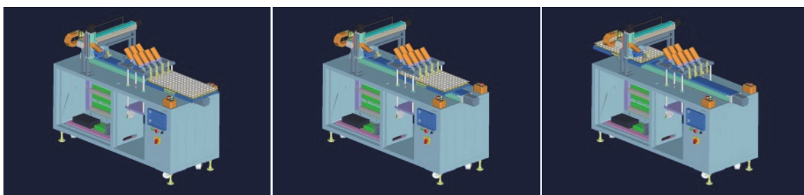
A. 縱向電剪固定，紙穴盤放置於不鏽鋼盤，並由右側進入 B. 紙穴盤前進，縱向電剪向下移動並啟動電剪作業 C. 紙穴盤持續前進到完全被剪斷成 8 條狀態
