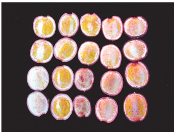
圖 7、經過正負氣旋交互作用抽吸 1 次的果漿殘留情形
