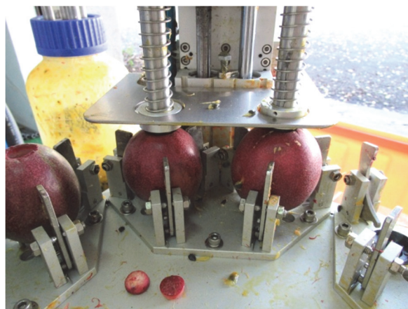
圖 6、百香果果漿抽吸機構以正負高壓氣旋交互作用進行果漿抽吸之情形
