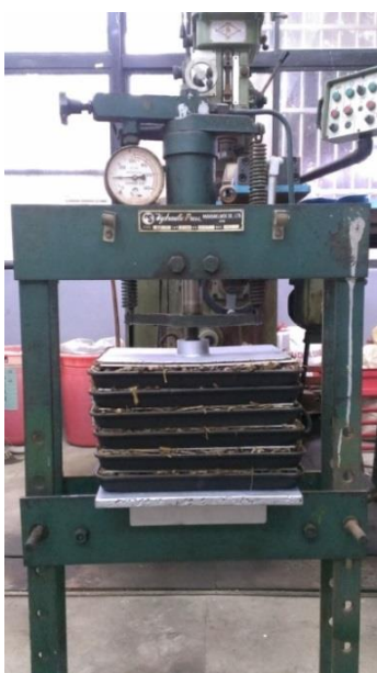
圖 5. 定壓壓製作業
