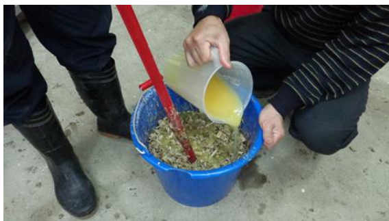
圖 3. 綠竹粉碎物混膠作業
